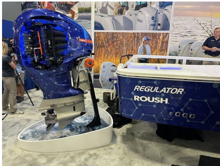
Kuva 11 Yamahan vetyperämootorin prototyyppi (Kuva: Yamaha)
