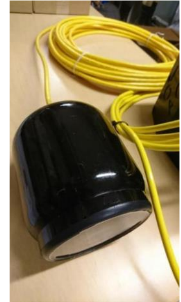
Lähetinyksikkö Ø 120 mm Pituus 195 mm
